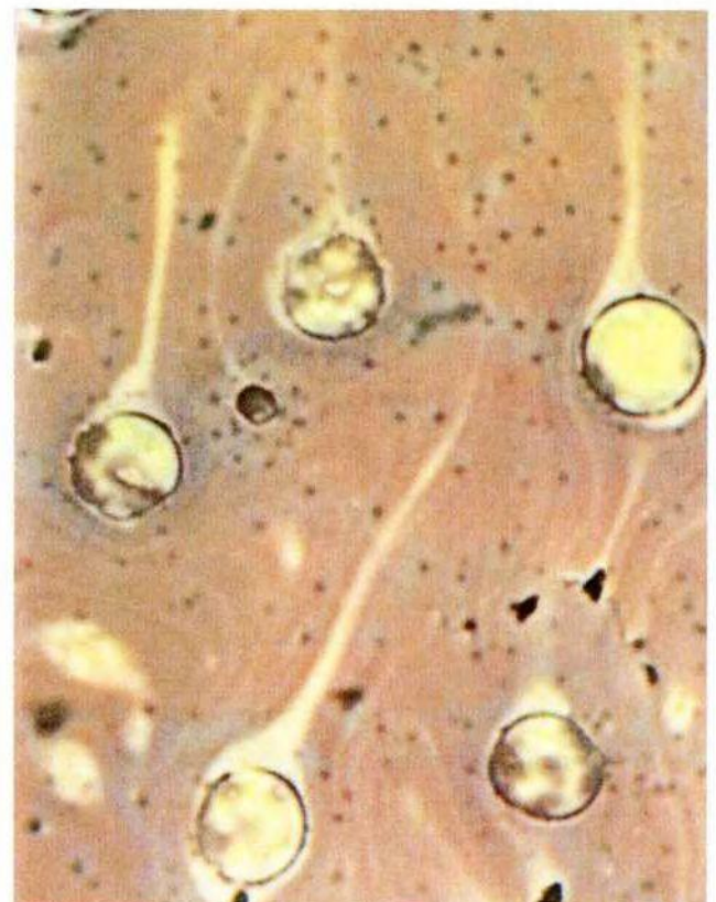
Abb. 410: Protitschleier, wie Fahnen zerfließend (helle Fließfähnchen von oben nach unten im Bild).
